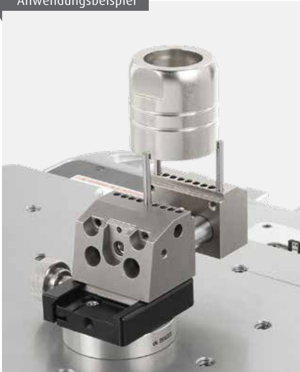
Außenspannung mit Überhöhung durch Stifte für optimale Zugänglichkeit aller Bereiche.
