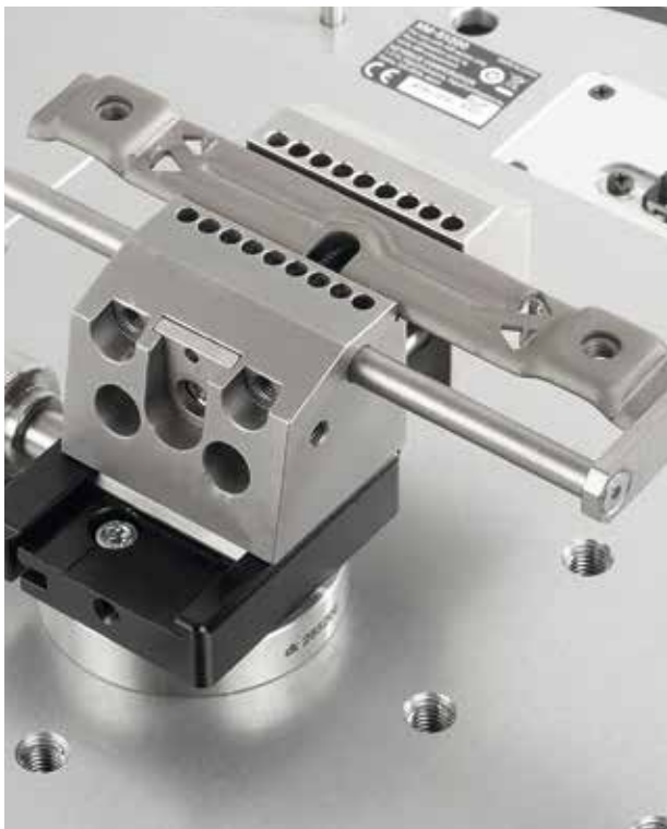
Wiederholgenaue Spannung mit verstellbarem Anschlag.
