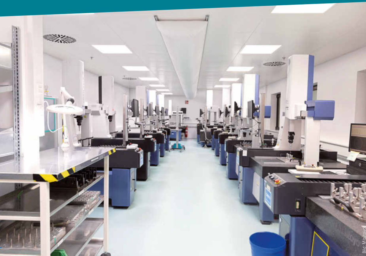
Der Blick in einen Raum der zentralen Prüftechnik – hier die Koordinatenmessgeräte, alle von Mitutoyo
